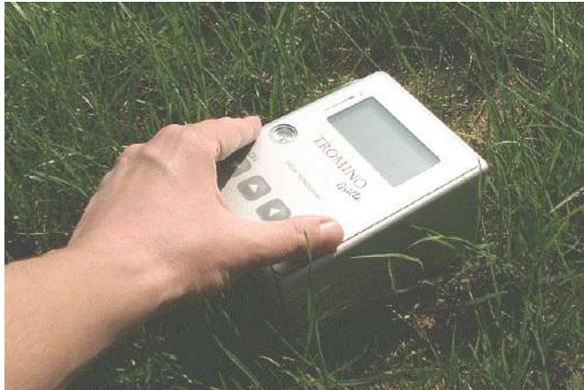
Illustrazione 2: Posizionamento del tromografo sul terreno. L'accoppiamento strumento - terreno è garantito dall'infissione nel terreno di particolari "piedini".
