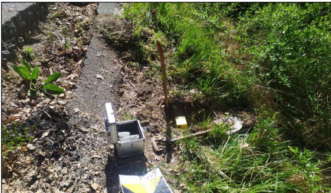
Foto n.4: Intervento A - Prova di sismica passiva H/V1
